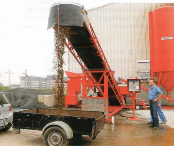
Die gewünschte Betonsorte wird im Mischmodul der Anlage hergestellt und anschließend mit Hilfe des höhenverstellbaren Transportbandes ausgegossen.
